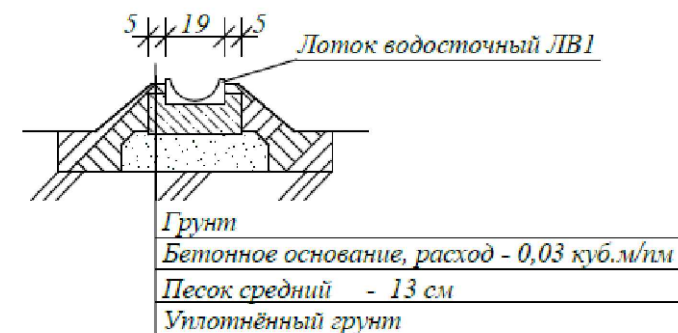
Схема устройства водоотводных лотков ЛВ1 в газоне
